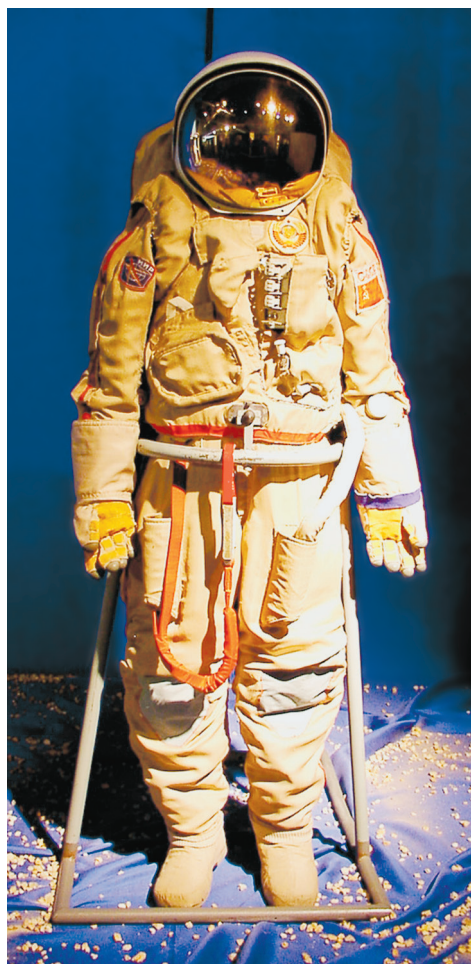
Отечественный скафандр «Орлан-Д», использованный в 1977–1984 гг. для ВКД на орбитальных станциях «Салют-6» и «Салют-7». НПП «Звезда» им. Г.И. Северина
