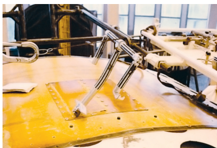
Инструменты ВКД: пробойник с защитным колпачком для образования отверстий в оболочке агрегатного отсека «Салюта-7»; резак для вскрытия крышек в рабочем положении (гидромакет корпуса агрегатного отсека)
