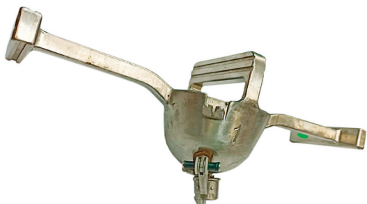
Инструменты ВКД: пробойник с защитным колпачком для образования отверстий в оболочке агрегатного отсека «Салюта-7»; резак для вскрытия крышек в рабочем положении (гидромакет корпуса агрегатного отсека)
