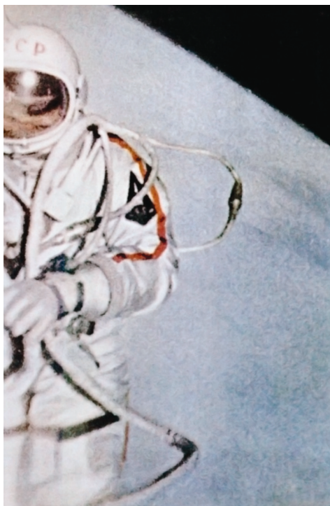
Выход А.А. Леонова из космического корабля «Восход-2» в открытый космос. Справа хорошо виден длинный фал, с помощью которого космонавт был соединен со шлюзовой камерой. 18 марта 1965 г. Фото РКК «Энергия» им. С.П. Королёва
